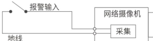
步骤2 连接报警输出设备，如图 1-3 所示。
