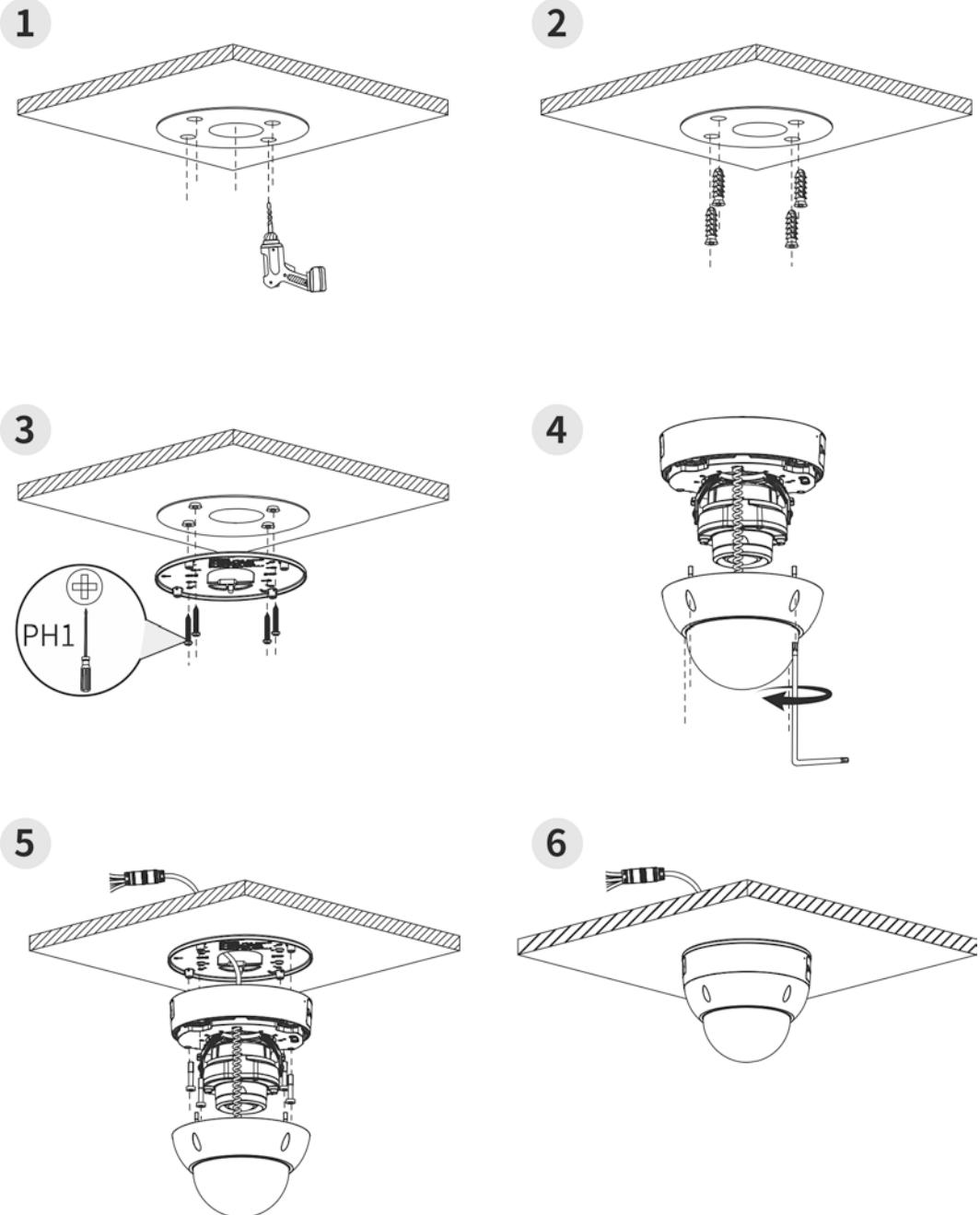
图3-6 不带快装板（出线槽出线）安装示意图
